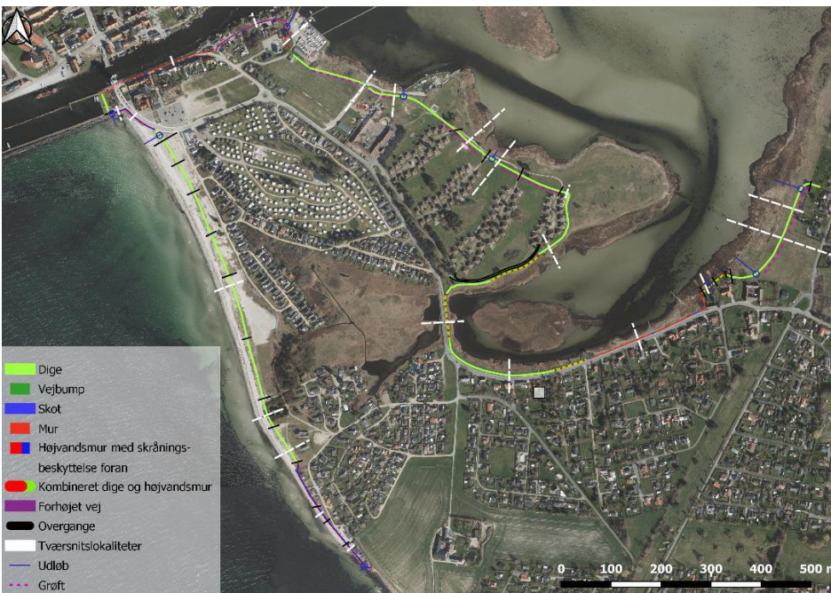
Overordnet løsningsforslag til højvandsbeskyttelse af det oversvømmelsestruede område på Enø og Lungshave.
